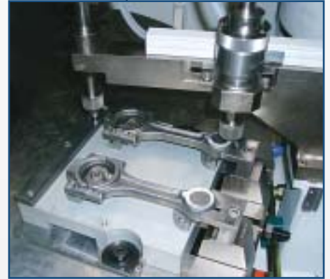
Spannstation und IONIC 17 A Messsystem jig and IONIC 17 A mesuring system
