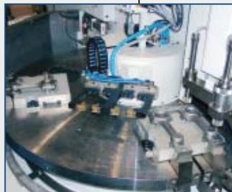
Wendegreifer und Spannstation swivel arm gripper and jig
